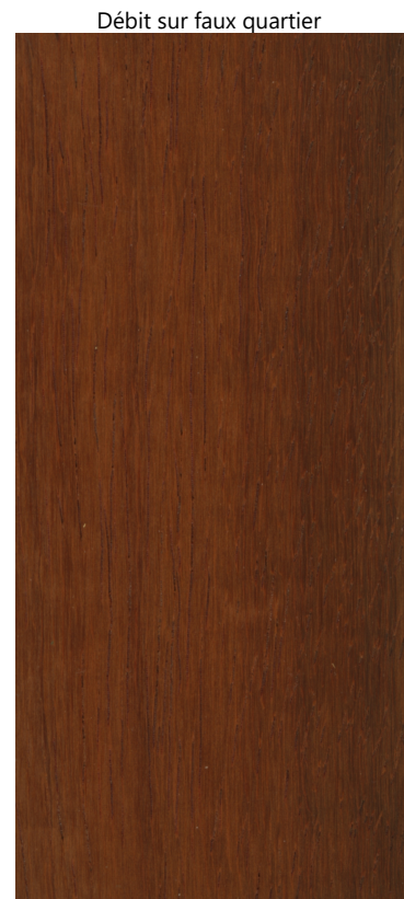
Débit sur faux quartier
